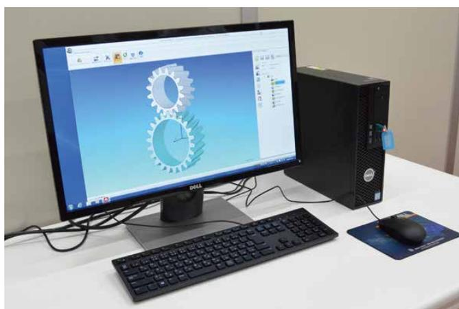
従来、試作歯車を製作するには専用工具を外部に製造委託してから加工を施すため、最低2ヵ月ほどかかっておりましたが、新たなシステムと機械を駆使することで**3週間程度に短縮**することが可能となりました。
